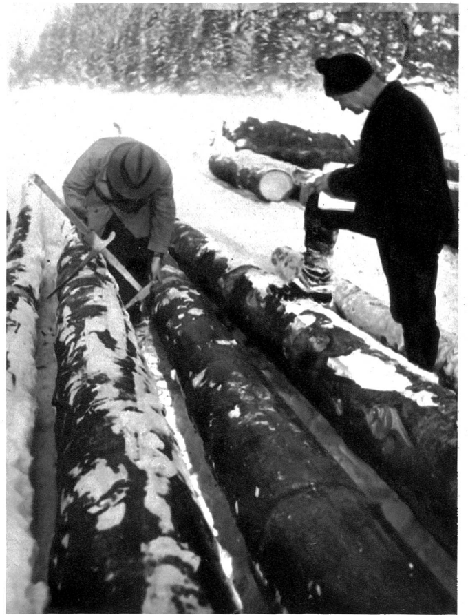
Zahlreiche Kubikmeter Laden sind auf den Sägereien aufgestapelt. Mit der Messkupe wird der Durchmesser eines einzelnen Stammes ermittelt. Es gibt Bauern, die über 100 Stämme in die Sägereien liefern
