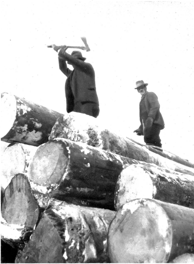
Das Aufsichten der schweren Trämel erfolgt maschinell. Oben auf dem Holzberg steht ein Mann, der dem Maschinisten bei den Motoren das Zeichen gibt, wenn der schwere Stamm oben in die richtige Lage gelangt ist
