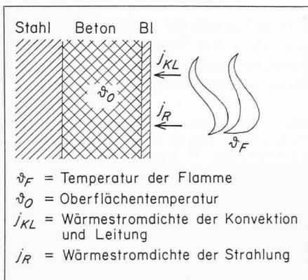
Bild 4. Wärmeübergang an der Oberfläche des Blechmantels
