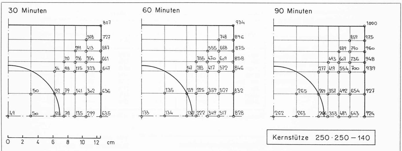
Bild 7. Temperaturentwicklung in Kernstütze 250 · 250-140
