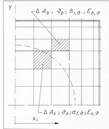
Bild 10. Berechnung der Knicklast bei erhöhten Temperaturen
