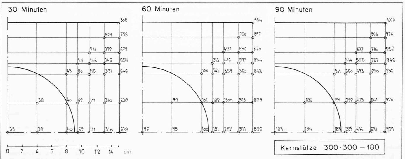
Bild 8. Temperaturentwicklung in Kernstütze 300 · 300-180
