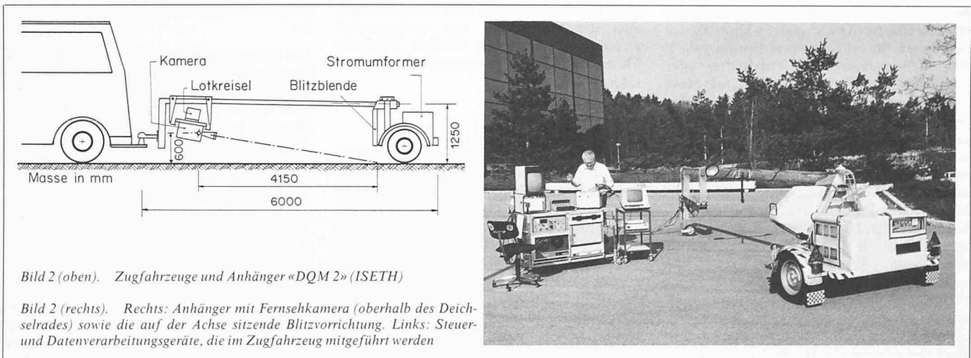
Bild 2 (oben). Zugfahrzeuge und Anhänger «DQM 2» (ISETH)
