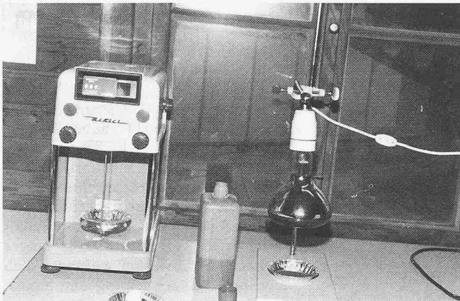
Bild 8. Bestimmung des Feststoffgehaltes mit Verwendung einer Infrarotlampe
