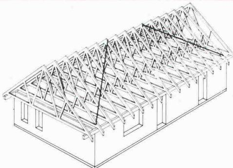
Aussteifung von Dachkonstruktionen.
