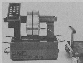
6 kW bereits die am häufigsten auftretenden Montageprobleme. Mit dem TIH 050 ist eine mikroprozessorgesteuerte zeit- oder temperaturabhängige Erwärmung möglich. Das zu erwärmende Werkstück kann auf diesem Gerät durch die eingebaute Regeleinrichtung längere Zeit auf einer vorgewählten Temperatur gehalten werden. Sollen damit kleinere Teile erwärmt werden, so ist es möglich, ein «Sonderprogramm» vorzuwählen, wobei die Geräteleistung auf 50% reduziert wird.
