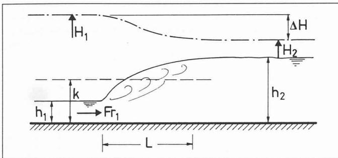
Bild 1 (oben). Wassersprungung zwischen den beiden Querschnitten 1 und 2 mit  $h$  als Abflusstiefe,  $H$  als Energiehöhe,  $k$  als kritische Tiefe,  $\Delta H$  als Energiedifferenz und  $L$  als Sprunglänge
