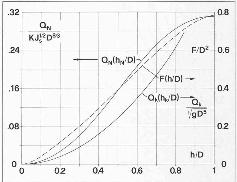
Bild 7 (rechts). Normalabflusstiefe (links im Bild) und kritische Tiefe, Fläche (rechts im Bild) im Kreisprofil
