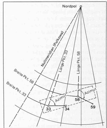
Bild 5 (rechts). Astronomische Längen und Breiten. Einpassen der Routenaufnahmen
