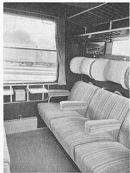
Fig. 10. Compartiment de 1 re classe des voitures de 26,4 m de longueur de la DB. Les 6 sièges ont leurs dossiers légèrement inclinables; leurs parclozes peuvent être rapprochées pour former 3 places couchées.
