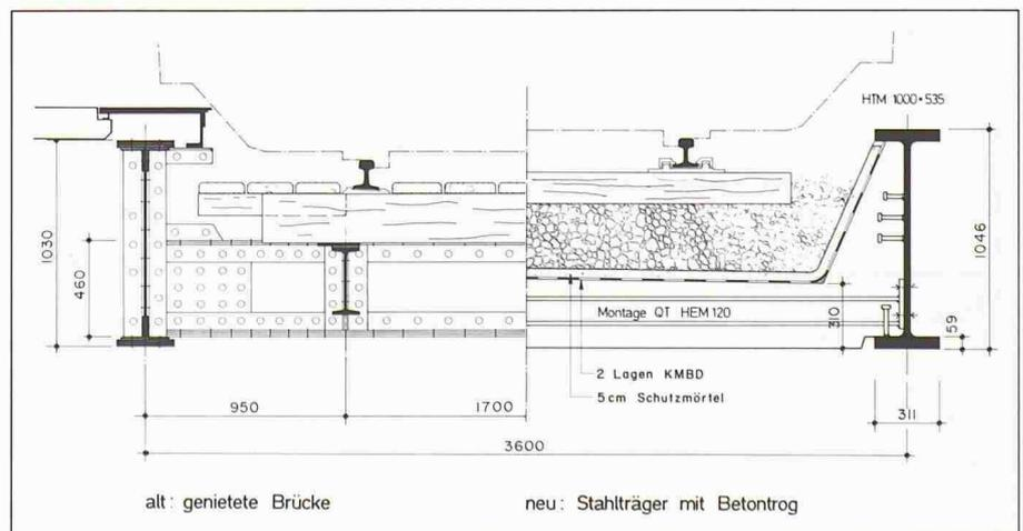
Bild 3. Brückenquerschnitt
