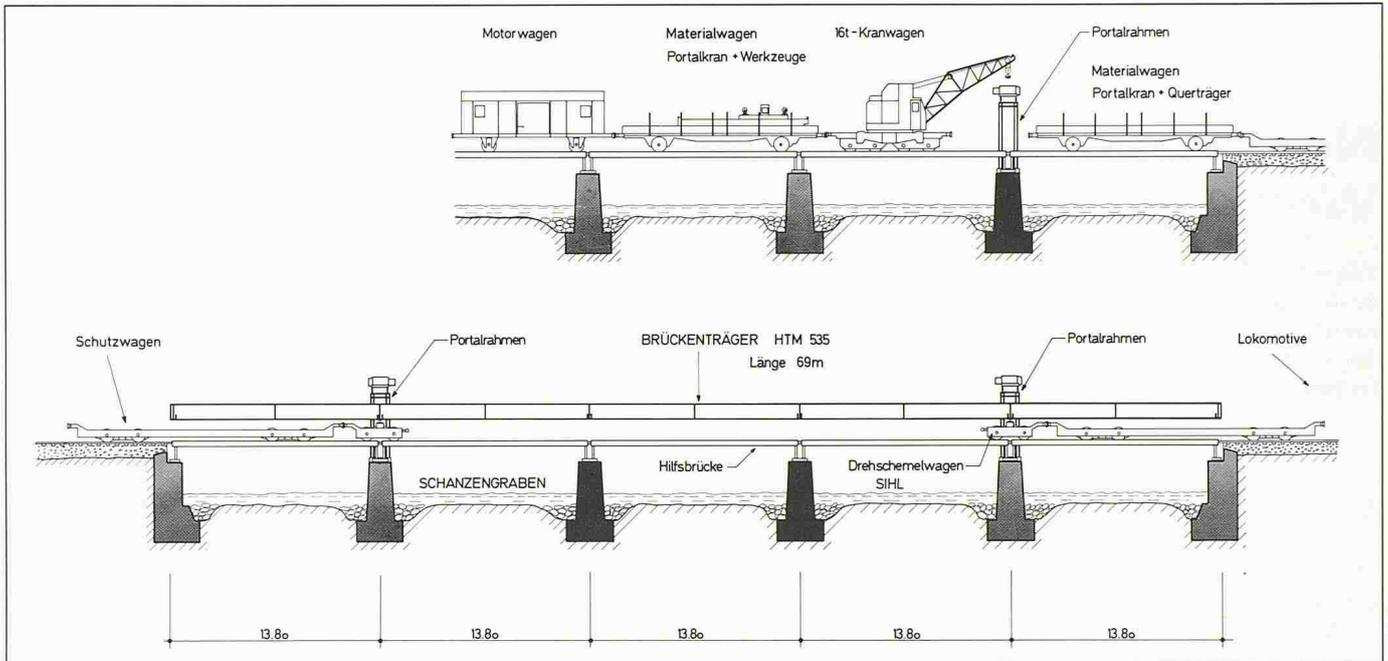
Bild 6. Montage der Portalrahmen und Brückenlängsträger-Antransport
