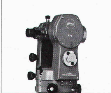
Kern K 1-S. Ingenieurtheodolit mit Skalenablesung
