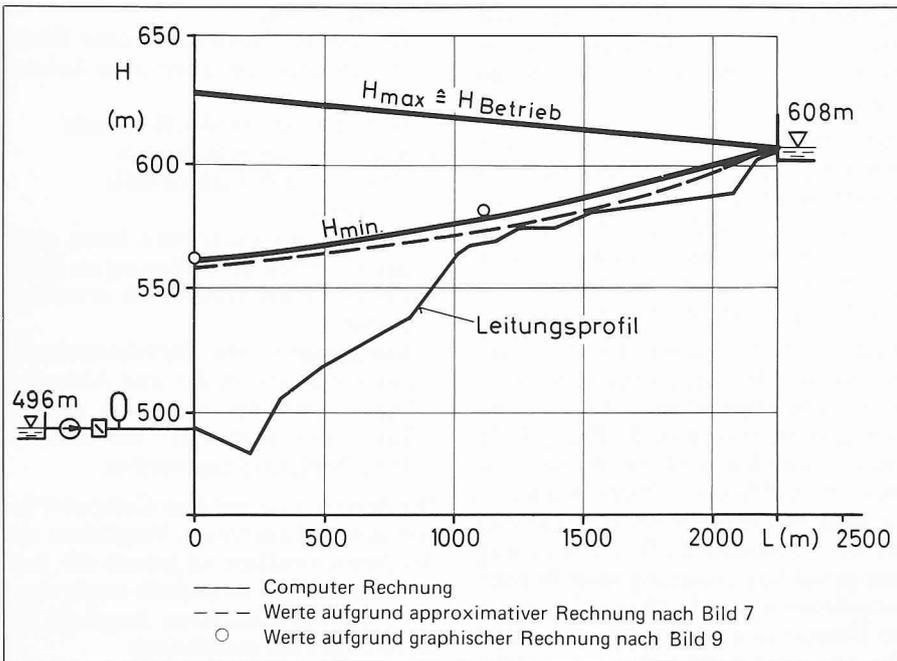
Bild 13. Anlage Lyren. Extremdrücke entlang der Leitung
