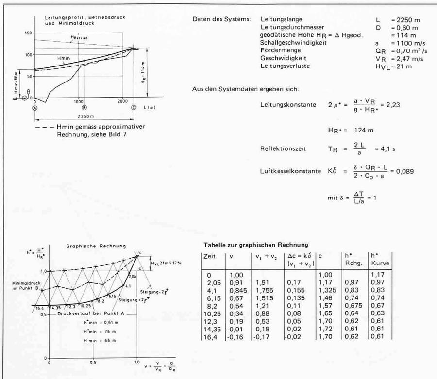
gangen. Graphische Berechnungen werden heute *nur noch in Ausnahmefällen* durchgeführt und dann vorwiegend für *Luftkesselanlagen*. Dabei wird nach der *Methode von Parmakian* [5] gerechnet.
