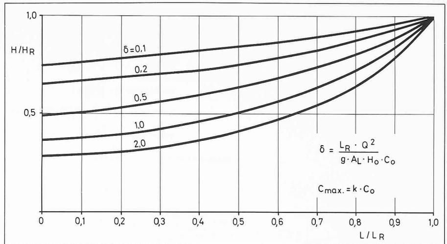
Bild 5. Approximation für Luftkessel, Druckverlauf entlang der Leitung
