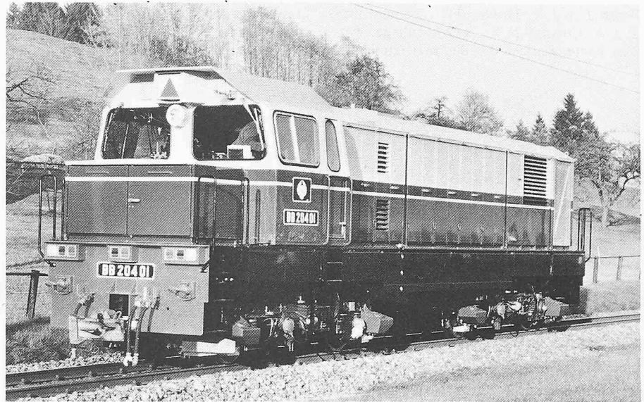
Die neue Zahnrad- und Adhäsionslokomotive HGm 4/6 auf Testfahrt auf einem Streckenabschnitt der Appenzellerbahn (Schweiz)
