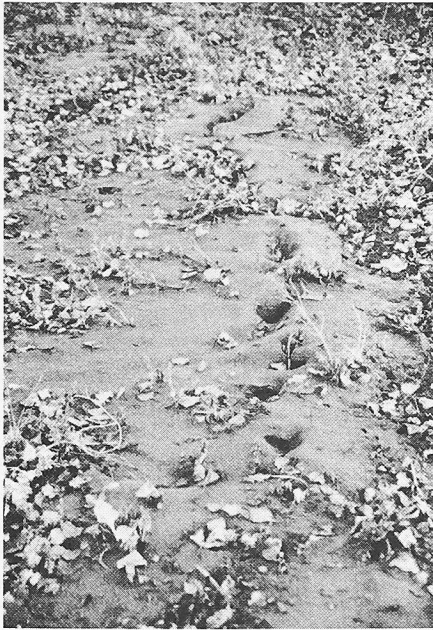
Bild 11. Bodenverflüssigungserscheinungen (Sandausspülungen) in alluvialen Flussablagerungen in der Nähe der Eisenbahnstation von San Angelo dei Lombardi
