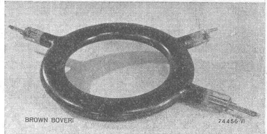
Bild 2. Betatron-Kreisröhre mit zwei Elektronenspritzen und einem Stutzen für das Getter. Die evakuierte Röhre muß einem Druck von 7 t standhalten
