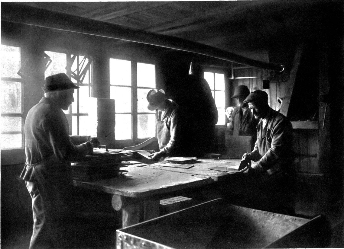
In der Hütte. Spalten u. Schneiden der Schieferplatten auf die gewünschten Dimensionen. Dicke 3,5—4 mm.
