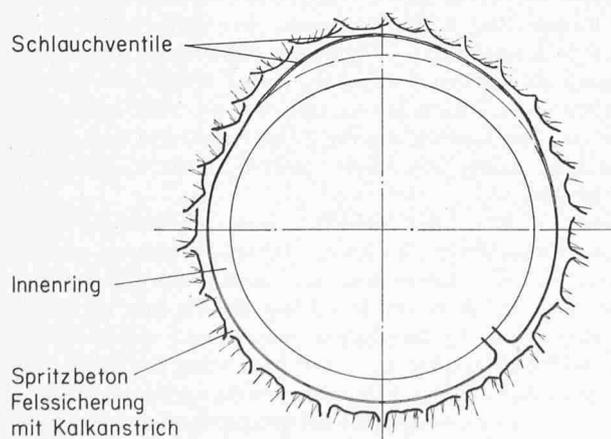
Bild 3. TIWAG-Spaltinjektionsverfahren
