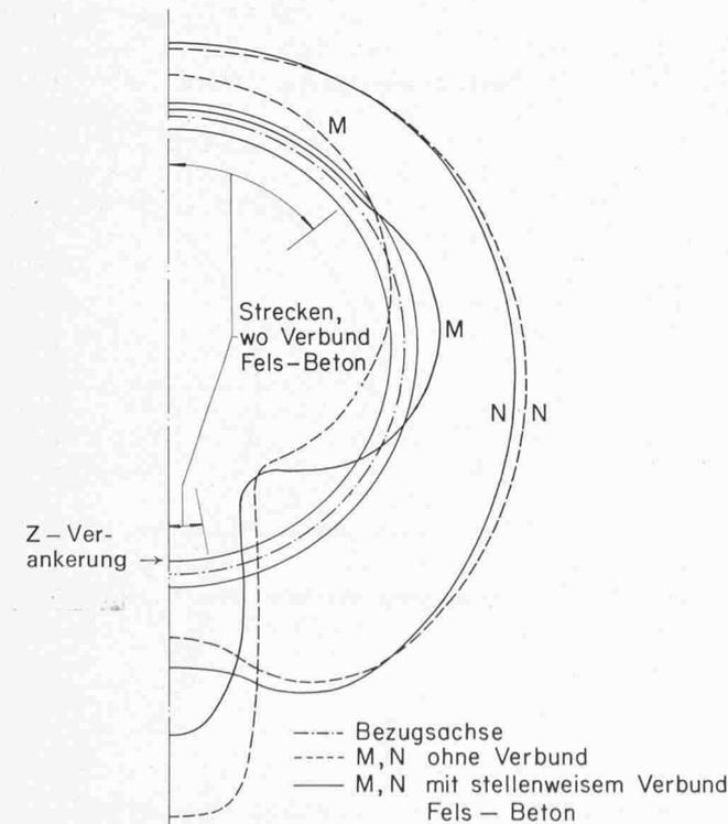
Bild 17. Momenten- und Normalkraftbeanspruchung bei fehlendem und bei stellenweise vorhandenem Verbund Fels-Beton
