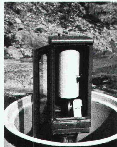
Wasserspiegelkontrollen mit Pegel
