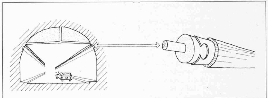
Bild 5. Antennenkabel
