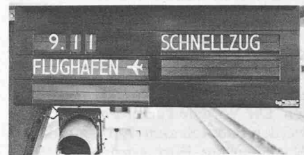
Bild 5. Zugabfahrtsanzeiger in Zürich Oerlikon
