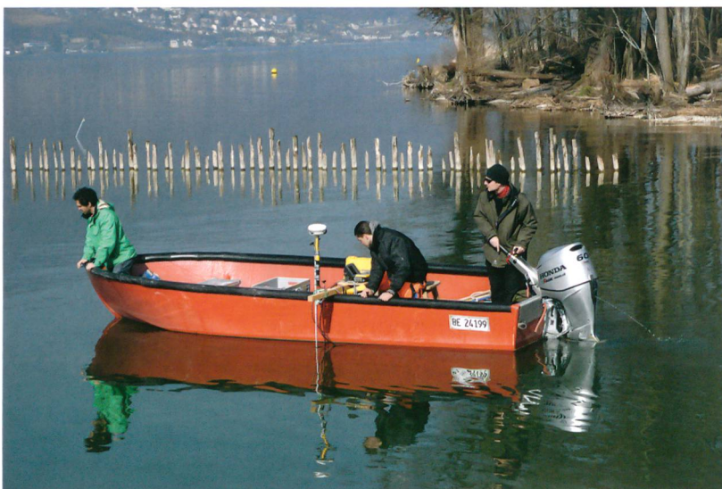
Abb. 2: Sutz-Lattrigen, Rütte. Mit dem Echolot wird der Seegrund vermessen.
