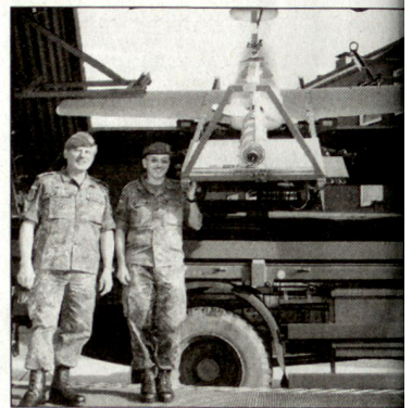
Startgerät für die Aufklärungsdrohne KZO (Kleinflugzeug-Zielortung).
