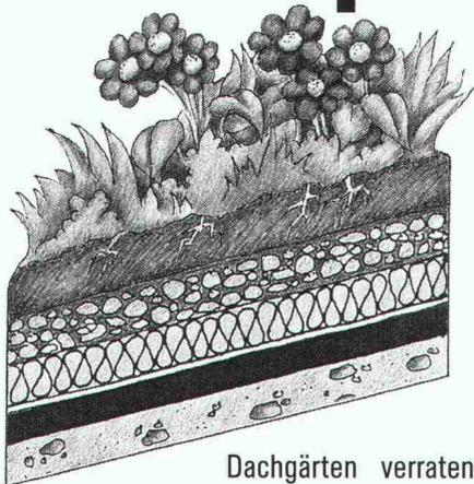
Dachgärten verraten nicht, wie es «darunter» aussieht. Erst ein Schnitt gibt Einblick in den Dachaufbau und lässt seine Stärken und Schwächen erkennen. Gussasphalt – ein natürlicher und umweltgerechter Baustoff – zeichnet sich durch seine robuste Einbaustärke aus, die am besten Dichtigkeit und Wurzelschutz garantiert. Verlangen Sie unsere Dokumentation über Dachgärten.
