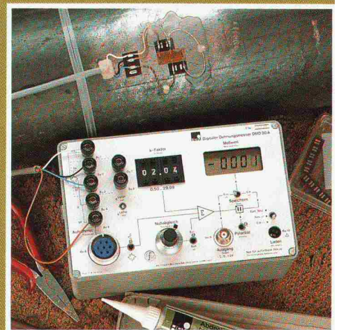
Experimentelle Spannungsanalyse vor Ort mit Dehnungsmessstreifen und mobilen Geräten
