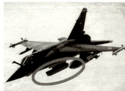
Capteur ELINT ASTAC emporté en station centrale sous un mirage F1CR de l'Armée de l'Air.
