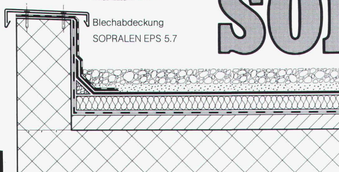
Schutzschicht SOPRALEN EJ 3.5 + EV 3.2 Wärmedämmschicht Dampfsperre
