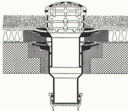
Flachdachablauf Guss zweiteilig, seitr. Auslauf 3° mit Kugelrost, Isolierring, Isolierkörper, Distanzringe 25+35 mm Höhe.
