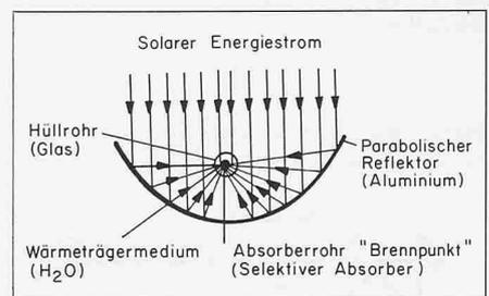
Bild 6. Parabolischer Sonnenkollektor
