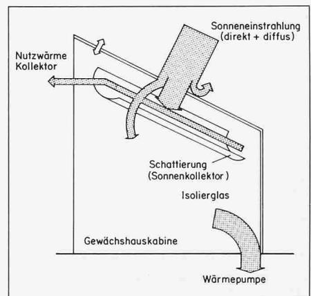
Bild 5. Energiebilanz Gewächshausdach mit Sonnenkollektoren und Wärmepumpe
