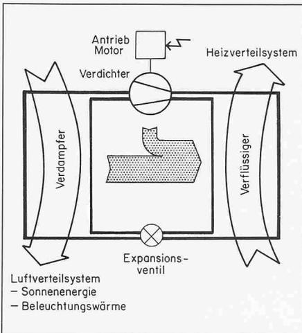
Bild 8. Wärmepumpe
