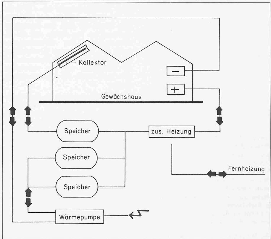
Bild 13. Energiefluss-Schema
