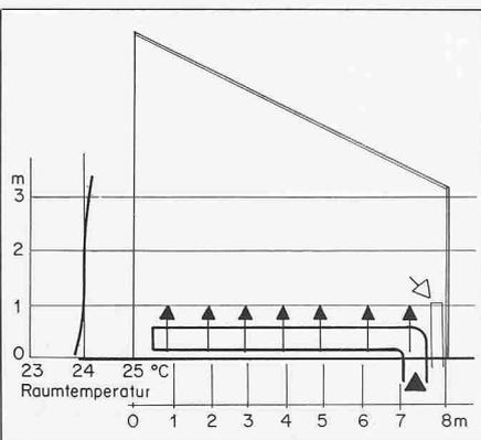
Bild 10. Luftverteilssystem. Temperaturverlauf (100 FLWh) in Abhängigkeit von der Raumhöhe
