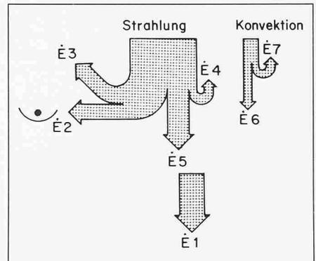
Bild 4. Energiebilanz Gewächshausdach mit Sonnenkollektoren und Wärmepumpenanlage
