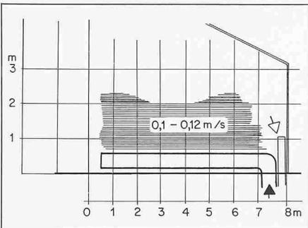
Bild 9. Luftverteilssystem. Topographie Raumluftbewegung 100 FLWh
