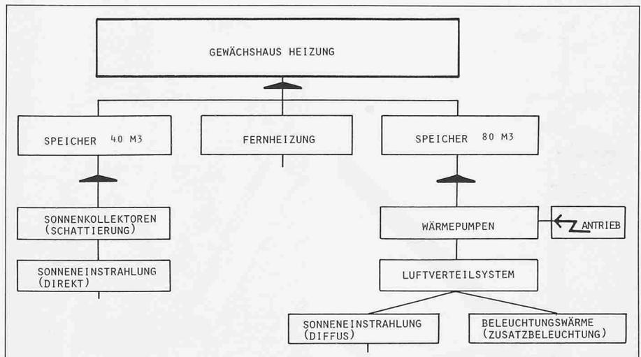
wächshaus dient, wird zusammen mit der *Wärmepumpen-, Wärmespeicheranlage* als *bivalentes Heiz- und Kühlsystem* alternativ betrieben (Bild 1).
