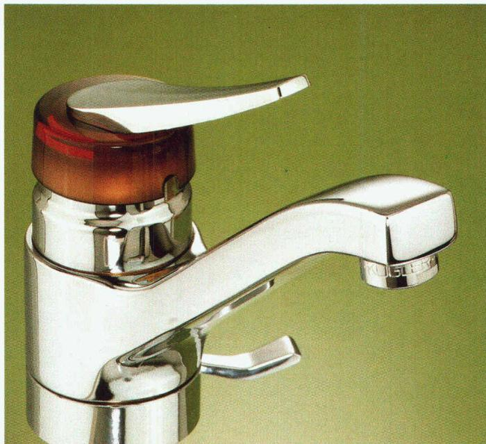
«Kuglodisc»-Einhebelmischer sind dank der modernen Keramikscheiben-Technik absolut dicht, verschleissfest und korrosionsbeständig. Eine Fingerbewegung für auf, zu, kalt und warm genügt. Höchsttemperatur-Begrenzung und Feinregulierung. Grosse Temperatur Mischkomfortzone im Bereich 30-40 Grad.
