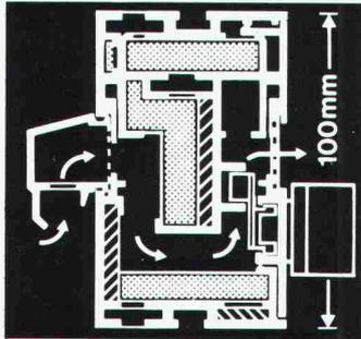
Zuluft-Elemente Typ ZE 100 sorgen für Frischluft und schützen vor Lärm. Sie fügen sich in jeden Blendrahmen und Glasfalz und sind darum – bei Sanierungen etwa – die ideale Lösung.
