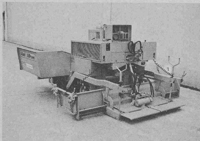
Der Allatt SP-50 hat eine einteilige Vibrationsbohle von 137 cm Grundbreite, die hydraulisch stufenlos bis 251 cm verbreitert werden kann. Das Materialsilos mit einem Fassungsvermögen von 3,6 t ist 291 cm breit und lässt sich mit jedem gebräuchli-
