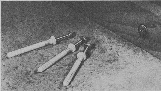
Befestigungselement, das gegenüber den herkömmlichen Kunststoffdübeln wesentliche handhabungstechnische Vorteile bietet. Der neue Hilti-Schlagdübel HPS besteht aus einem Kunststoffdübel (Polyamid) mit vormontierter Nagelschraube als Spreizelement. Dübel einstecken und mit Hammerschlag spreizen - das genügt. Die Hauptvorteile des Hilti-Schlagdübels HPS sind:
