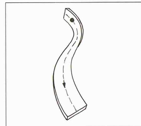
Bild 6. «Parallele» Führung von mehreren Kugeln mittels Querneigung einer Fläche
