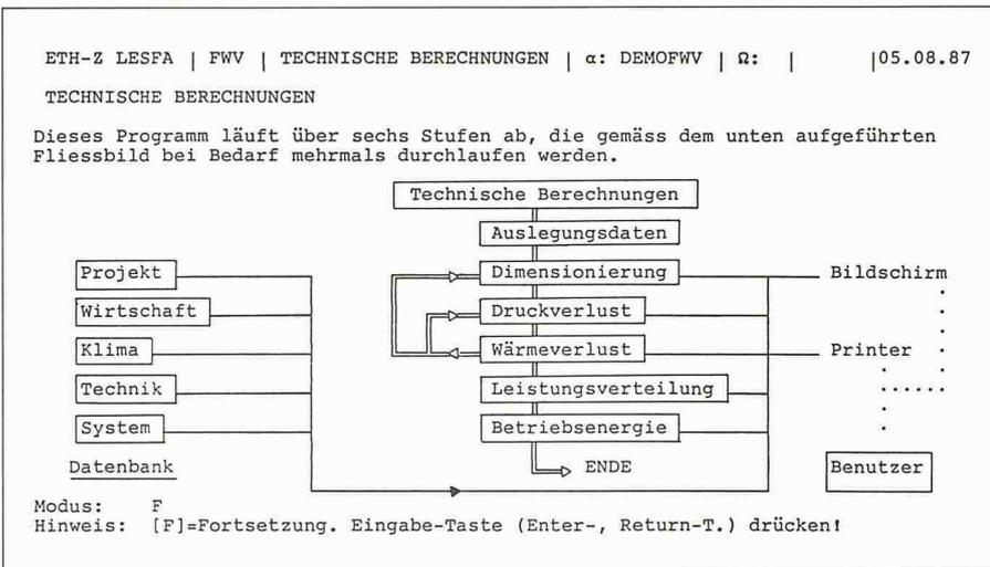
Bild 2. Bildschirmdarstellung des Flussdiagrammes der technischen Berechnungen
