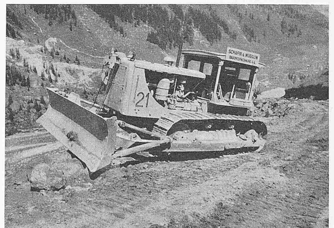
Bild 2. Bulldozer Caterpillar D 8, Gewicht 22 t, Motorenleistung 190 PS
