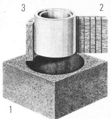
Dieser Aufbau verhindert die Wärme- und Schallübertragung. Zudem ist das runde Innenrohr am strömungsgünstigsten.
