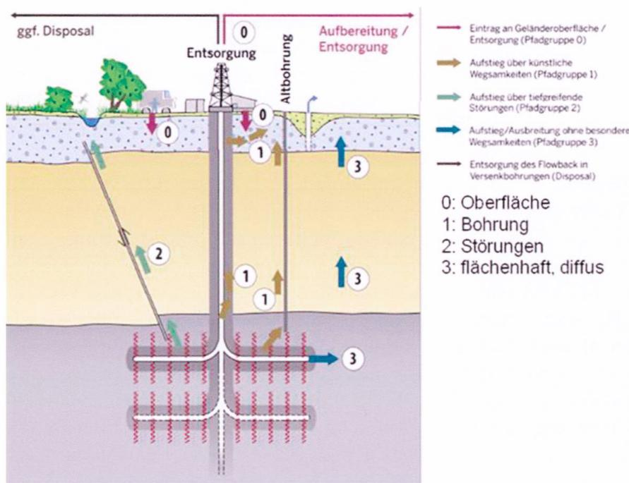
Fig. 4: Schematische Darstellung potenzieller Wirkungspfade (Meiners, et al. 2012).
