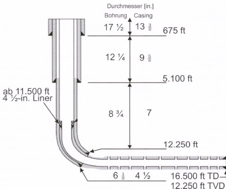
Fig. 2: Beispielhaftes Verrohrungsschema einer Horizontalbohrung (nicht massstäblich). TD: Länge der Bohrung gemessen vom Bohransatzpunkt (total depth); TVD: Vertikaler Abstand des Bohrlochtieftesten zum Bohransatzpunkt (true vertical depth); Massangaben: 1 ft = 0.3048 m; 1 in. = 2.54 cm (aus Meiners et al., 2012, nach Rohwer et al. 2006).
