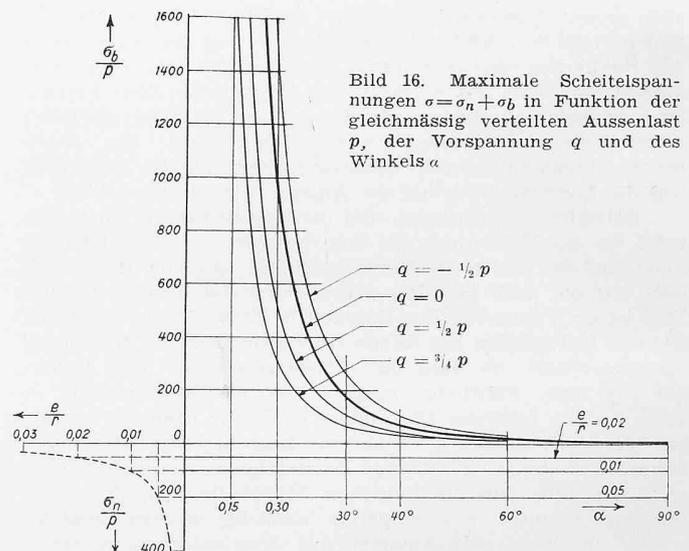
Bild 16. Maximale Scheitelspannungen  $\sigma = \sigma_n + \sigma_b$  in Funktion der gleichmässig verteilten Aussenlast  $p$ , der Vorspannung  $q$  und des Winkels  $\alpha$
