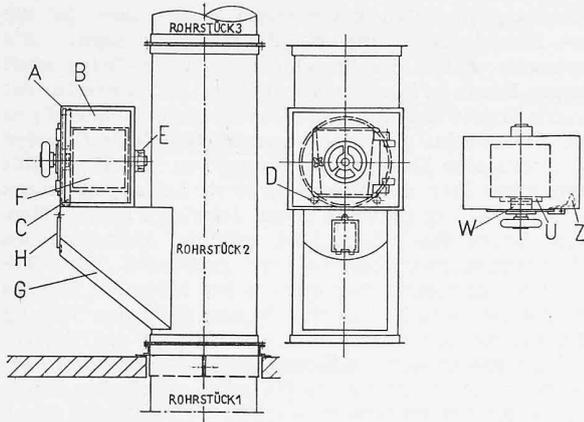
Bild 1. Anordnung der Aufgabestation und des Fallrohres
