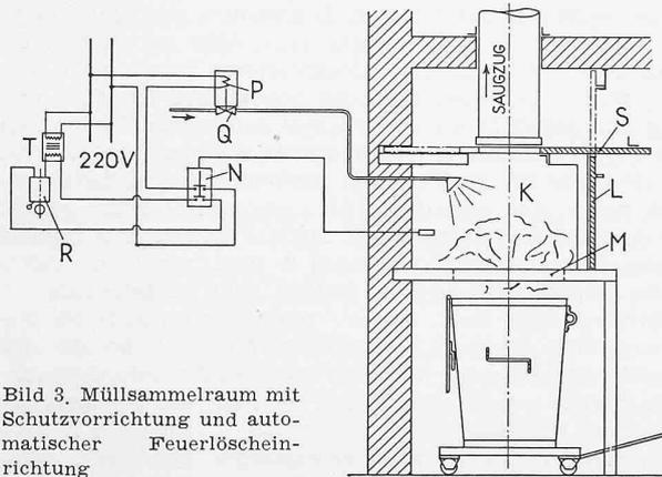
Bild 3. Müllsammelraum mit Schutzvorrichtung und automatischer Feuerlöscheinrichtung
