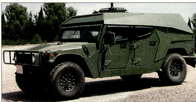
Neue, zusätzlich geschützte Version des Geländefahrzeugs HMMWV.
