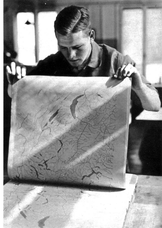
Ein Probeabzug wird vom Stein abgenommen
