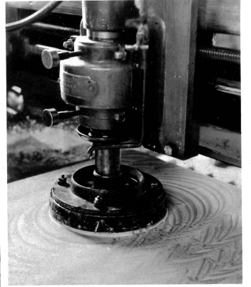
Schleifen des Lithographiesteines
