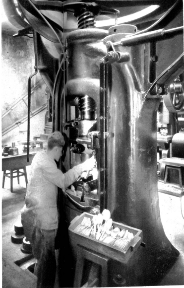
An dieser Maschine werden Tischbestecke geprägt
