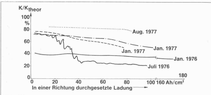
Bild 3. Relative Kapazität  $K/K_{theor}$  von Na/S-Versuchszellen als Funktion der in einer Richtung pro  $cm^2$  durchgesetzten Ladung  $K$  = gemessene Kapazität,  $K_{theor}$  = Kapazität, die einer Stöchiometrieänderung im Schwefelraum von reinem Schwefel bis  $Na_2S_2$  entspricht
