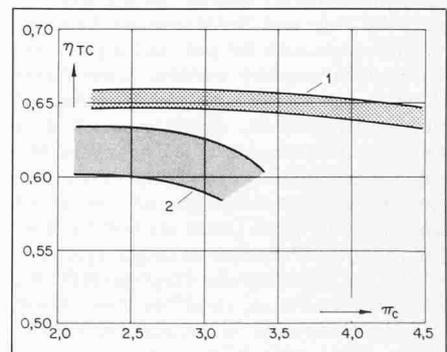
Bild 2. Turboladerwirkungsgrad, Vergleich VTR 454/VTR 501.  $\eta_{TC}$ : Gesamtwirkungsgrad des Turboladers (Bereiche für verschiedene Turboladerspezifikationen),  $\pi_C$ : Verdichterverhältnis (1 VTR 454, 2 VTR 501, in Produktion seit 1970, Wirkungsgraderhöhung seit 1975)
