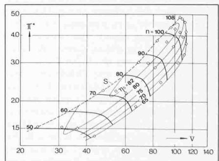
Bild 3. Turboladerverdichter-Kennfeld VTR 454  $n$ : bezogene Drehzahl (%),  $v$ : bezogener Luftdurchsatz (%),  $\epsilon_s$ : isentropen Wirkungsgrad bezogen auf Totalzustand (%),  $\pi^*$ : Verdichter-Totaldruckverhältnis, S: Pumpgrenze
