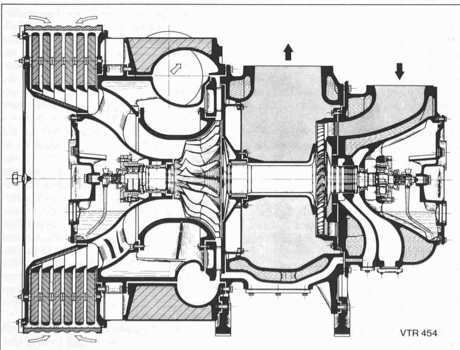
Bild 1. Schnittzeichnung eines VTR 454 (1978). Druckverhältnis für Dauerleistung  $p_2/p_1 = 4$ ; Luftmenge  $V_1$  ca. 7 bis 12 m<sup>3</sup>/s totale Länge ca. 1,9 m. Anwendung für Dieselmotoren von 4000 bis 6000 kW Leistung
