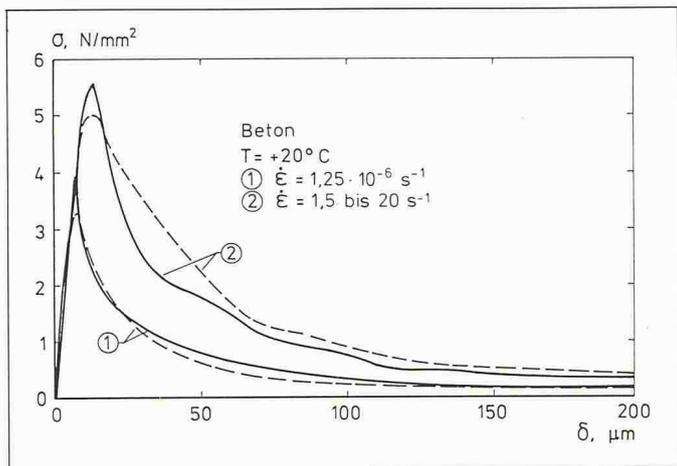
Bild 1. Vollständige Spannungs-Verformungs-Linie von Beton bei Zugbelastung [2]
