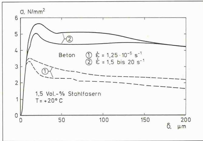
Bild 2. Spannungs-Verformungslinie von Stahlfaserbeton bei Zugbelastung [2]
