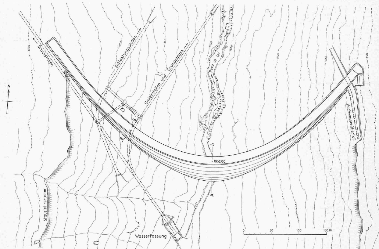
Bild 4. Die Staumauer Lei, Grundriss 1:4000
