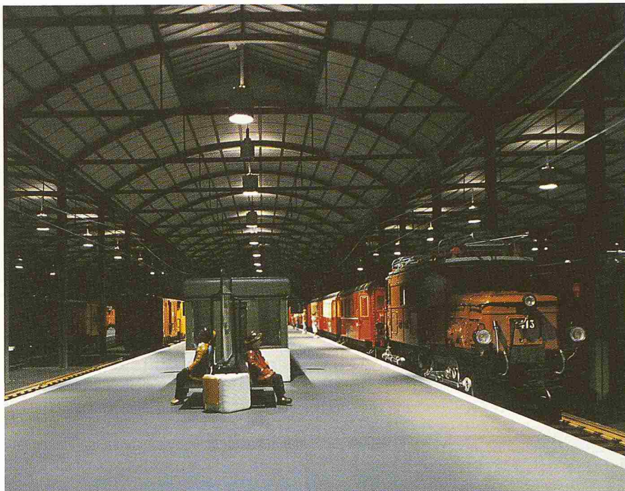
Bild 3. Beleuchtungsversuch am Modell (Foto P. Bartenbach, München)
