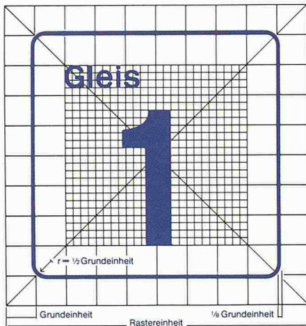
Das Zeichenbinnenfeld umfasst 8 x 8 Grundeinheiten. Ein Feld in der Breite einer Grundeinheit trennt die Zeichnung auf allen 4 Seiten von der Umrisslinie. Die Stärke der Umrisslinie beträgt 1/4 der Grundeinheit. Die Ecken sind mit dem Radius einer halben Grundeinheit abgerundet. Alle Zeichen stehen auf dem nach aussen begrenzten Feld von maximal 6 x 6 Grundeinheiten. Diese sind wiederum in einen Feinraster von 4 x 4 Einheiten unterteilt.
