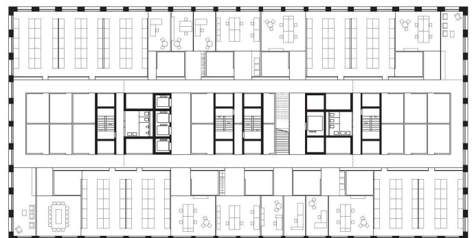
05 + 06 «Biozentrum»: Monolith mit gelochter Fassade; funktionaler Grundriss mit zentralem Kern (Bild + Plan: Christ & Gantenbein Architects)
