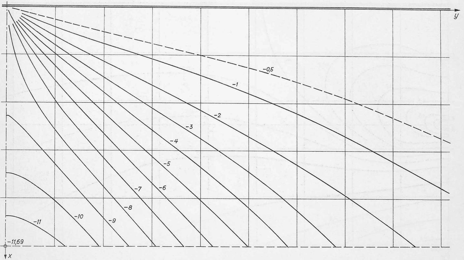
$m_x$ -Stützmoment-Einflussfeld für den eingespannten Rand eines Kragstreifens (8  $\pi$ -fach)
