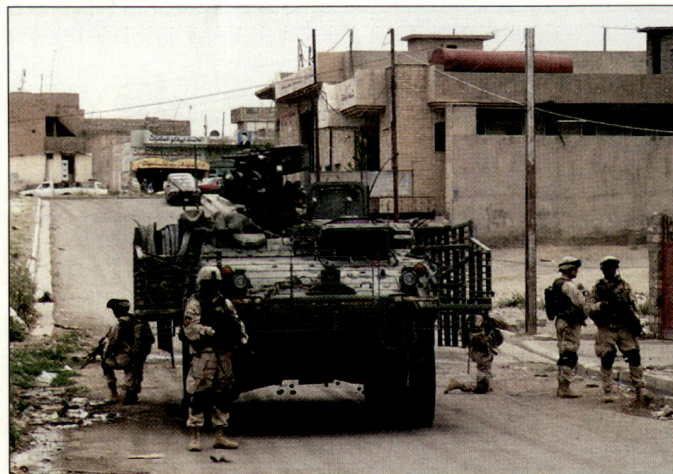
Schützenpanzer «Stryker» mit Begleitinfanterie. Der angebrachte Zusatzschutz (slat armour) soll vor allem vor Hohlladungsgranaten schützen.
